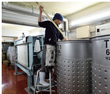
4フロアで約171㎡のコンパクトな醸造所。酵母を生育した麹・蒸米を水に混ぜる仕込みの様子。かき混ぜているのは、杜氏の寺澤さん。
